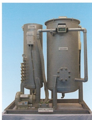
日さく型簡易土壌ガス吸引システム(地上部)
