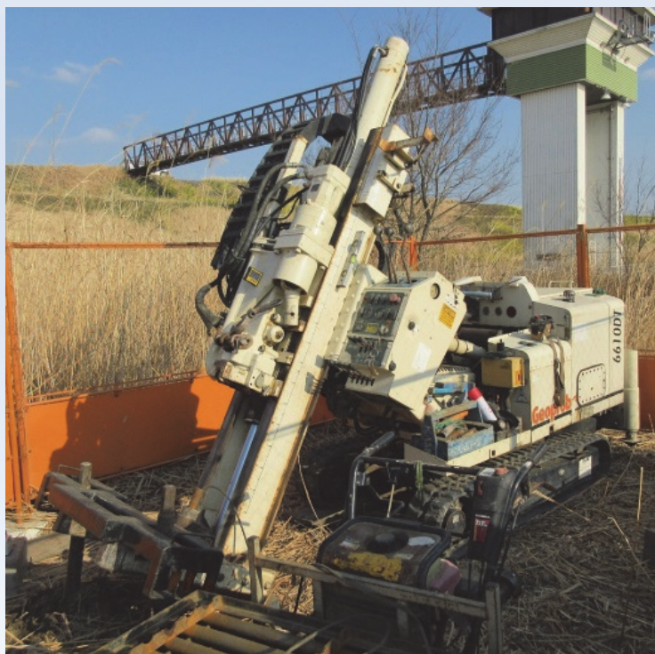
写真-1 斜め CPT 実施例(45° 斜め貫入)
