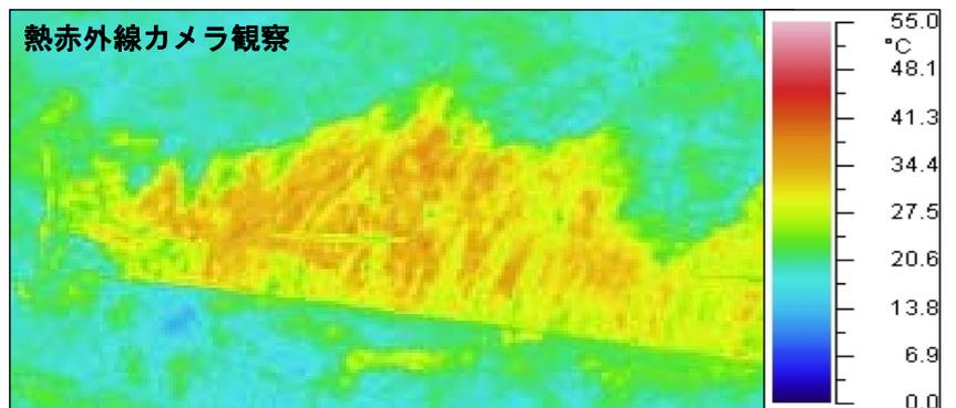
《モルタル吹付のり面の老朽化状況》
