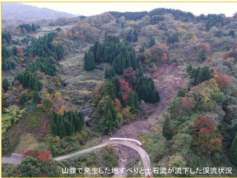
山腹で発生した地すべりと土石流が流下した溪流状況
