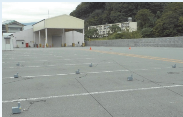
写真-2 地震計設置状況
