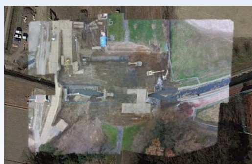
図-3 Google Earth 上に作成したオルソ画像を重ね合わせて表示
