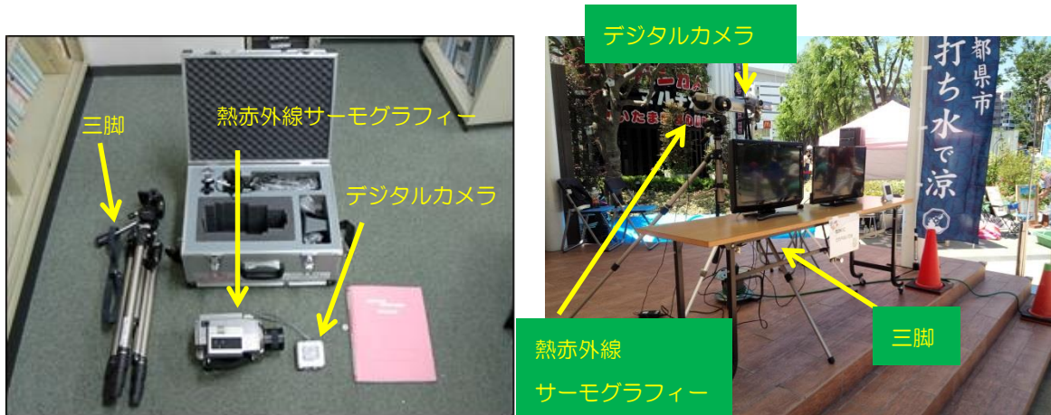
写真 1.5 測定機材一式（左）および撮影風景（右）
