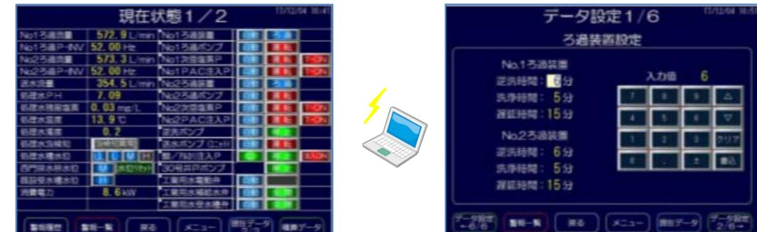
現場システム制御盤と同様の操作・設定変更等がパソコン(遠隔)で行えます
