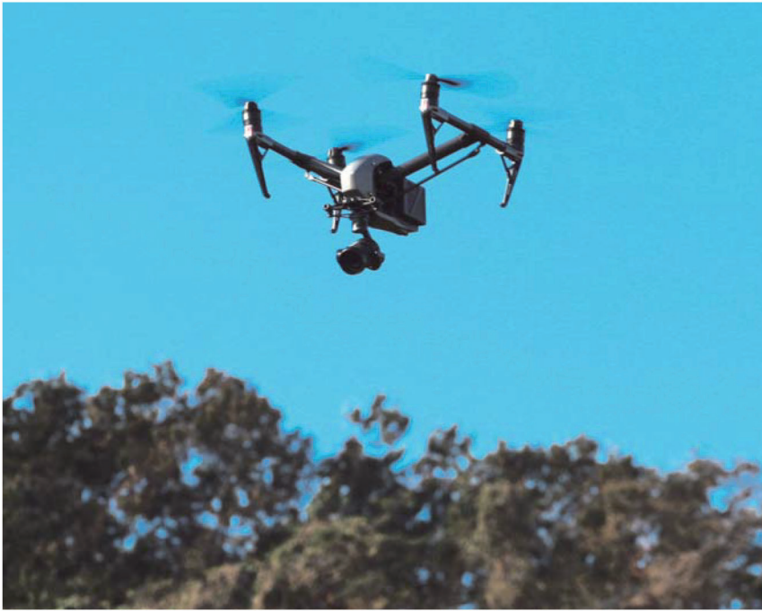
地滑り調査に用いるドローン。広範囲の地表面を短時間で計測できる
