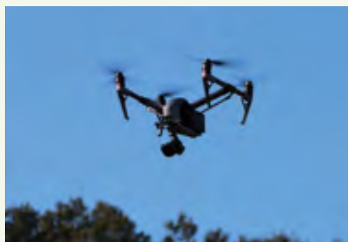
写真撮影、動画撮影することにより斜面災害等の 現地状況を把握するUAV調査
