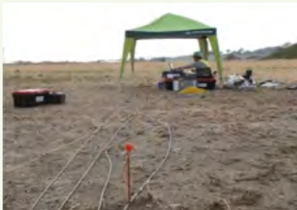
地下水の流動状況を把握するための 高密度電気探査
