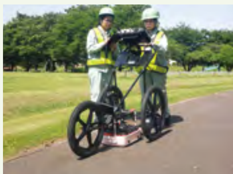
埋設部や空洞を把握するための 地中レーダー探査
