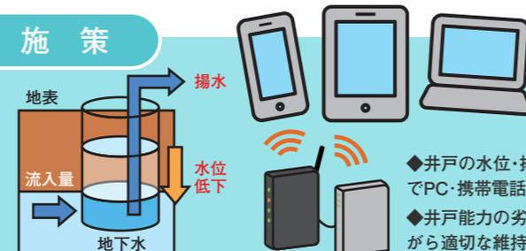
◆井戸の水位・揚水量をIoT機器でPC・携帯電話へデータ送信
