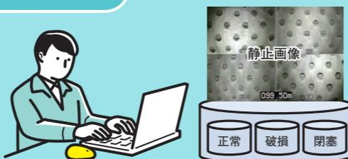
◆井戸内映像をAIを用いて「正常」「破損」「閉塞」に自動で分類し静止画像にして抽出
